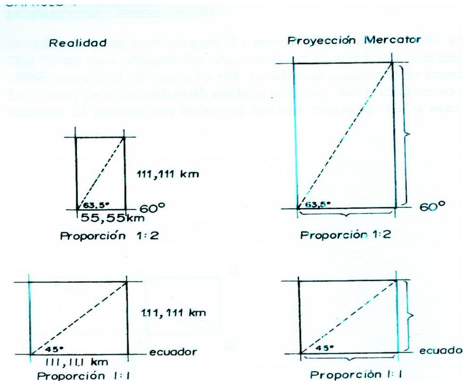
En todos los desarrollos cilíndricos, en éste los meridianos y paralelos vienen representados por rectas paralelas entre sí, pero aquí con la condición de ser conforme la representación
