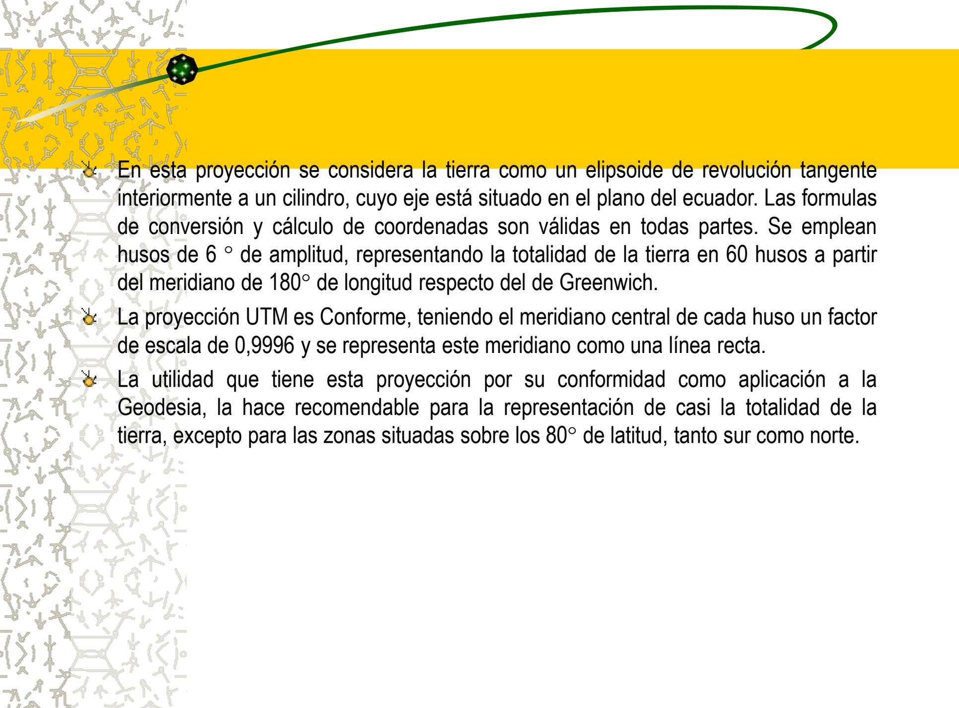
• En esta proyección se considera la tierra como un elipsoide de revolución tangente interiormente a un cilindro, cuyo eje está situado en el plano del ecuador. Las formulas de conversión y cálculo de coordenadas son válidas en todas partes. Se emplean husos de  $6^\circ$  de amplitud, representando la totalidad de la tierra en 60 husos a partir del meridiano de  $180^\circ$  de longitud respecto del de Greenwich.
